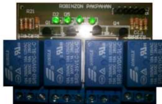
Gambar 5. Relai pengontrol sumber tegangan
